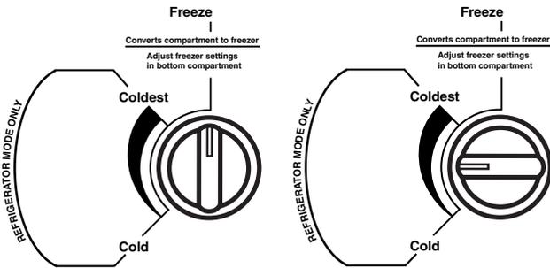
**IMPORTANT :** Si la commande est réglée entre FREEZE (congélation) et COLDEST (le plus froid), le compartiment supérieur ne fonctionnera peut-être pas au mode désiré. La commande devrait être réglée complètement à FREEZE pour une bonne congélation ou dans la plage entre COLD (froid) et COLDEST pour une bonne réfrigération.
